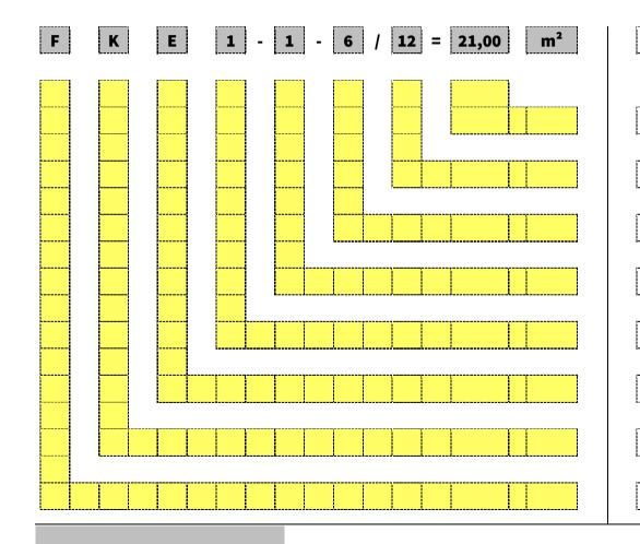
Weitere Bauformen und Optionen erhalten Sie auf Anfrage!!! 8. Stelle Filterfläche Elementgröße (**08**=2,25 m<sup>2</sup> / **10**=2,80 m<sup>2</sup> / **12**=3,50 m<sup>2</sup>) 7. Stelle 6. Stelle Modul (6er, 9er und 10er) 5. Stelle Anzahl der Module in der Höhe 4. Stelle Anzahl der Module in der Breite 3. Stelle **E**=Einbau / **A**=Aufsatz / **G**=Gehäuse 2. Stelle Kompaktfilter
