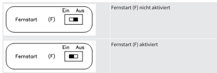
Ist die Fernbedienungsfunktion aktiviert, startet der Abreinigungsvorgang sobald 1 Signal an Eingang F liegt. Die LED leuchtet.
